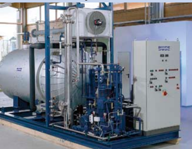
Kompakte CO 2 -Rückgewinnungsanlage für 30 kg/h
