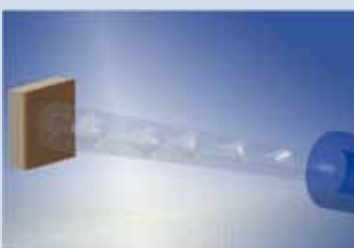
Trockeneis pellets werden auf eine Geschwindigkeit von ca. 300 m/s beschleunigt
