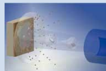
Eindringen von Gas in die aufgerissene Oberfläche und Ablösen der Verschmutzung durch nachfolgende Pellets
