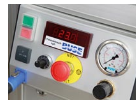
Panel de control con regulador de flujo de hielo seco, indicador digital de consumo y regulador integrado de presión de blasteo
