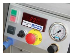
Обзорное табло управления с регулятором сухого льда, цифровым показанием расхода и интегрированным регулятором струйного давления
