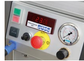
Kuru buz ayarlamalı, dijital tüketim göstergeli ve entegre püskürtme basıncı ayarlayıcılı kumanda panosu
